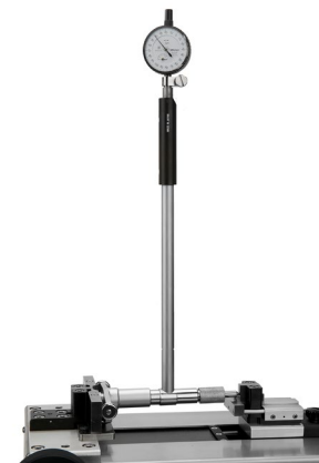
Voreinstellen von Innenfeinmessgeräten Pre-setting of bore gauge
