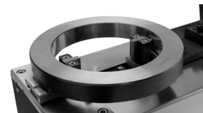
Messung von Innendurchmessern Measurement of inside diameters
